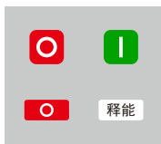
断路器断开且无储能状态
