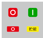
断路器断开且已储能完毕状态
