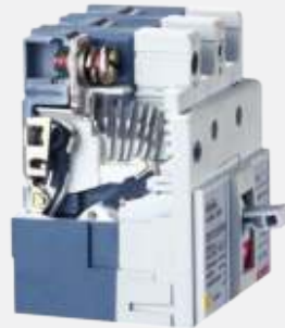
断路器处于脱扣分断位置，触头开距大于正常分断位置
